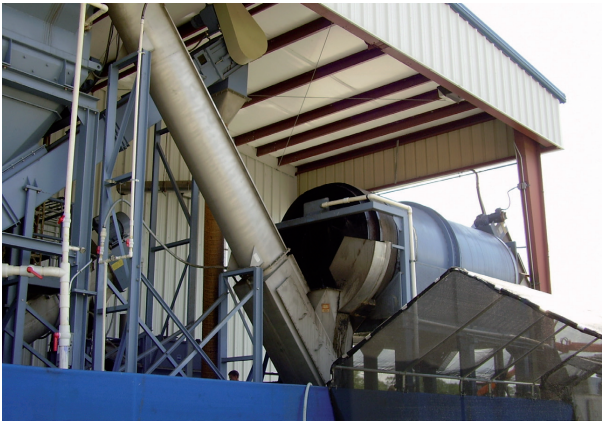
Fig. 5: Tambor de lavado para películas agrícolas con tornillo alimentador
