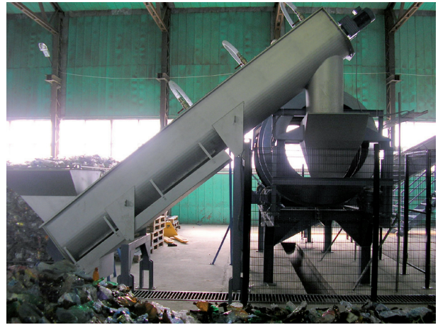
Fig. 4: Tambor de lavado PET con tornillo alimentador conectado
