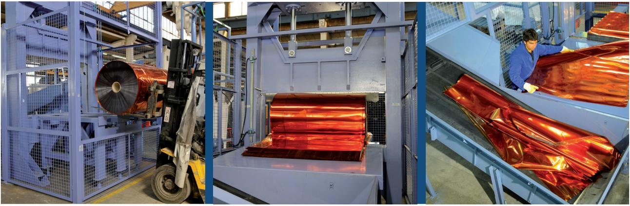
**Schritt 1:** Zuführung des Aufgabematerials erfolgt über den Stapler
