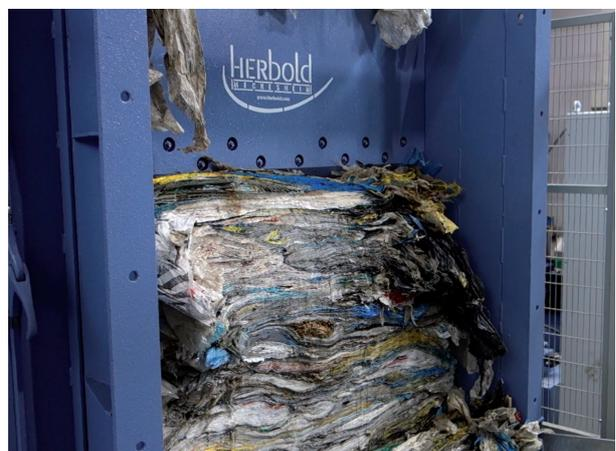
Abb. 2: Zerteilung der unter dem Spaltermesser liegenden Materialportionen
