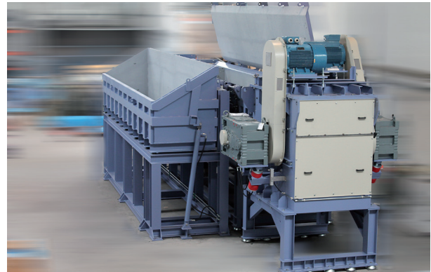
Paso 1: El material de alimentación es alimentado a la tolva depósito abatible
