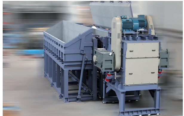
Schritt 1: Aufgabematerial wird der kippbaren Vorratswanne zugeführt
