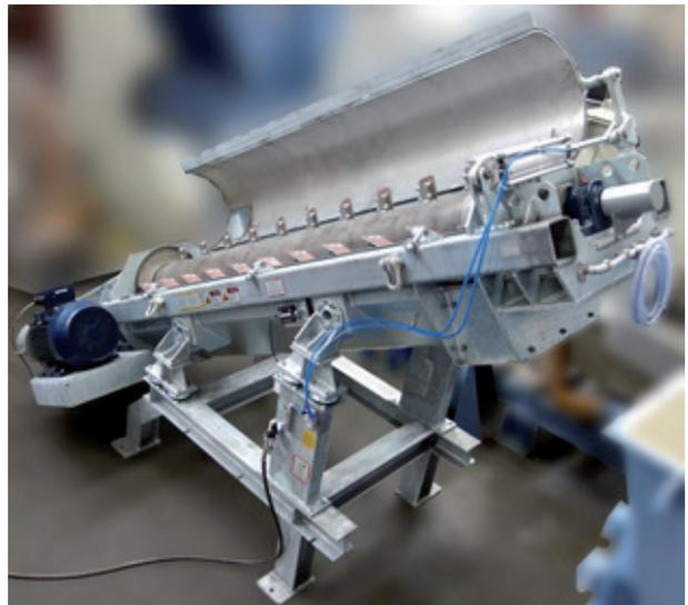
**Abb. 9:** Pneumatische Öffnung für Wartungszugang, Reduzierung von Stillstandszeiten
