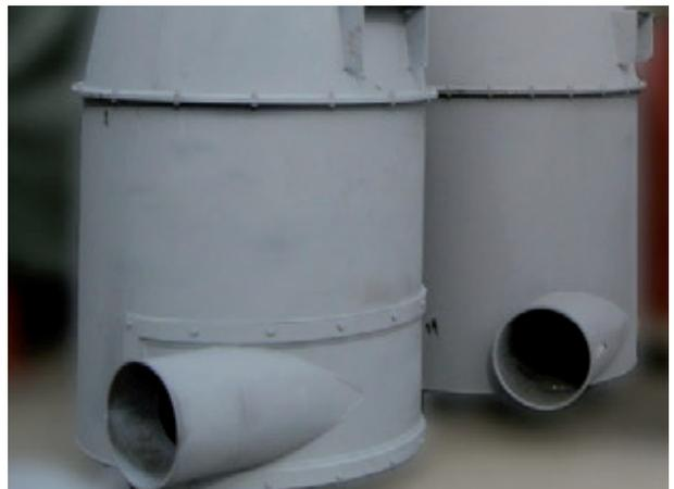
**Abb. 4:** Zyklonabscheider mit und ohne austauschbaren Aufprallbereich.
