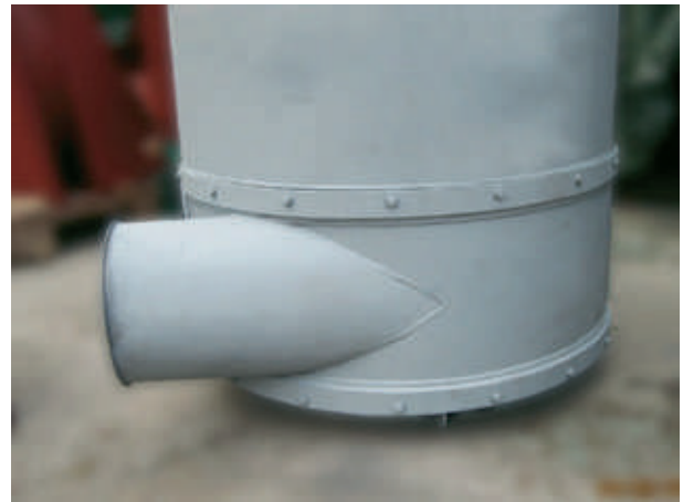
Abb. 3: HERBOLD Zyklonabscheider sind auch mit austauschbarem Aufprallbereich lieferbar!
