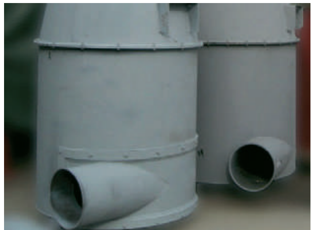
Abb. 4: Zyklonabscheider mit und ohne austauschbaren Aufprallbereich.
