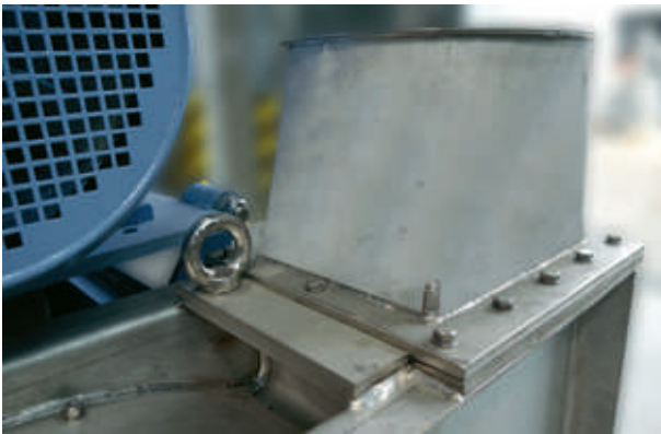
Abb. 6: ... sowie über austauschbare Saug- und Druckstutzen.
