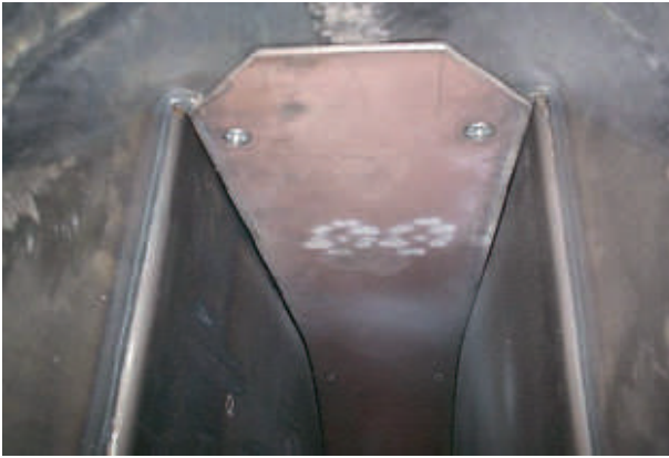
Abb. 5: Die Gebläse verfügen über eine austauschbare Verschleißeinlage ...
