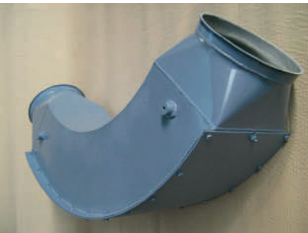
Abb. 2: Die Rohrbögen sind durch den austauschbaren Verschleißschutz wiederverwendbar .
