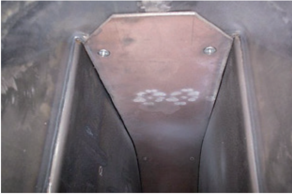
Fig. 5: Les ventilateurs sont équipés d'un insert anti-usure ...
