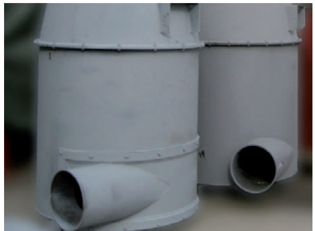
Fig. 4: Séparateurs à cyclone avec ou sans zone d'impact échangeable.
