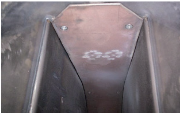
Foto 5: Los sopladores disponen de una pieza anti-desgaste recambiable ...
