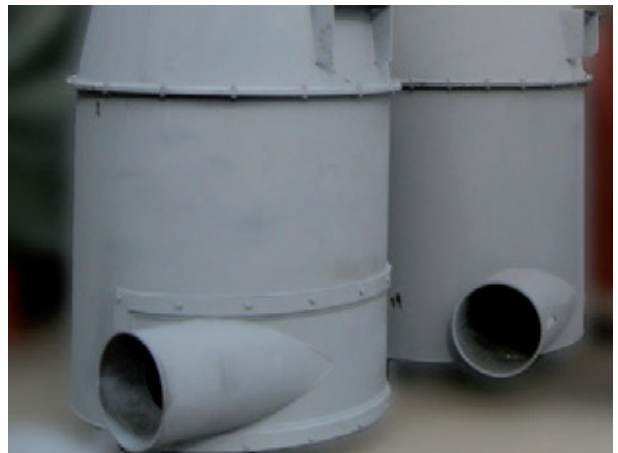
Foto 4: Separador por ciclón con y sin margen de rebote recambiable.
