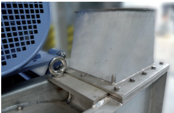
Foto 6: ... así como de manguitos de aspiración y presión también recambiables.
