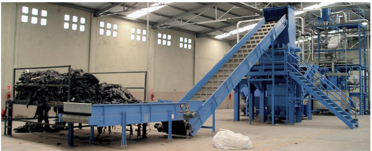
**Abb. 3:** Überflurförderband mit Sortiertisch zum Vereinzeln
