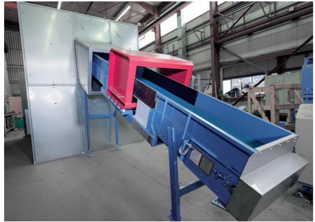
**Abb. 5:** Förderband mit Metalldetektor und Schallschutzkabine
