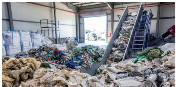
**Abb. 2:** Unterflurförderband zur Aufgabe von losen und individuellem Material
