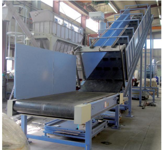
**Abb. 1:** Überflurförderband für ganze Ballen mit Materialaufgabeband, Entfernung der Bindedrähte von Hand
