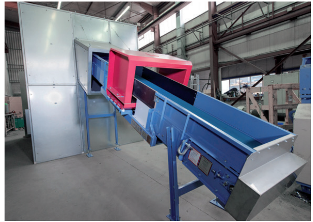
Fig. 5: Convoyeur à bande doté d'un détecteur de métaux et d'une cabine insonorisée
