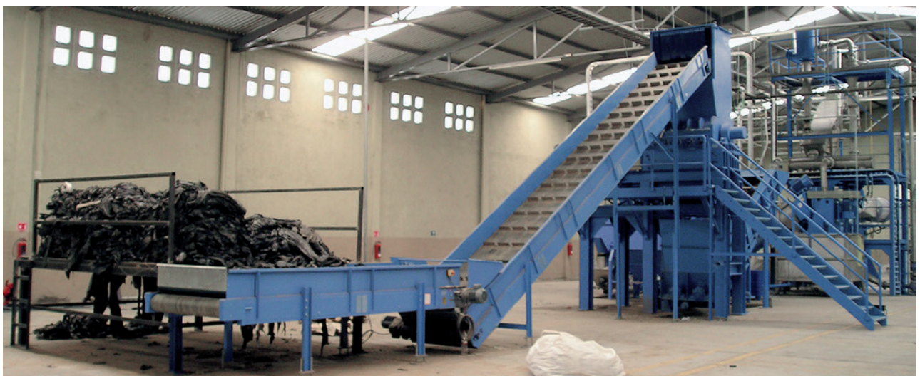
Fig. 3: Convoyeur à bande surélevé doté d'une table de triage pour les opérations de séparation
