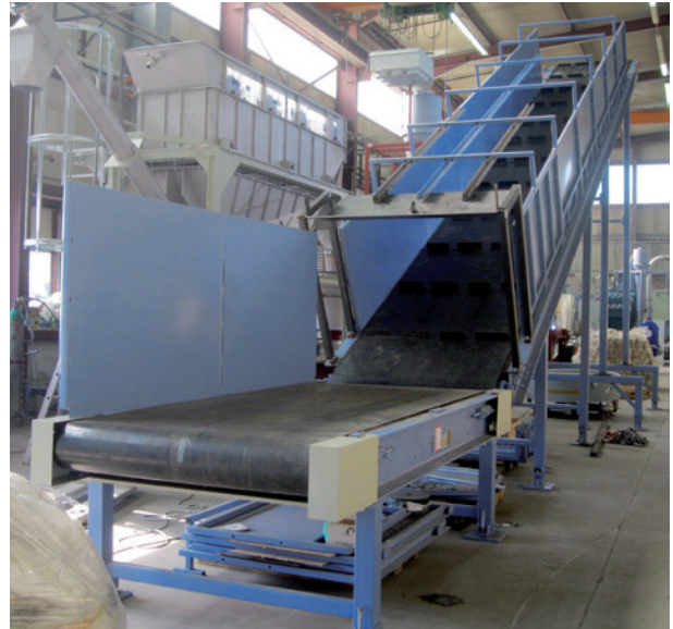
Fig. 1: Convoyeur surélevé pour balles entières, doté d'une bande d'alimentation; enlèvement manuel des fils d'attache
