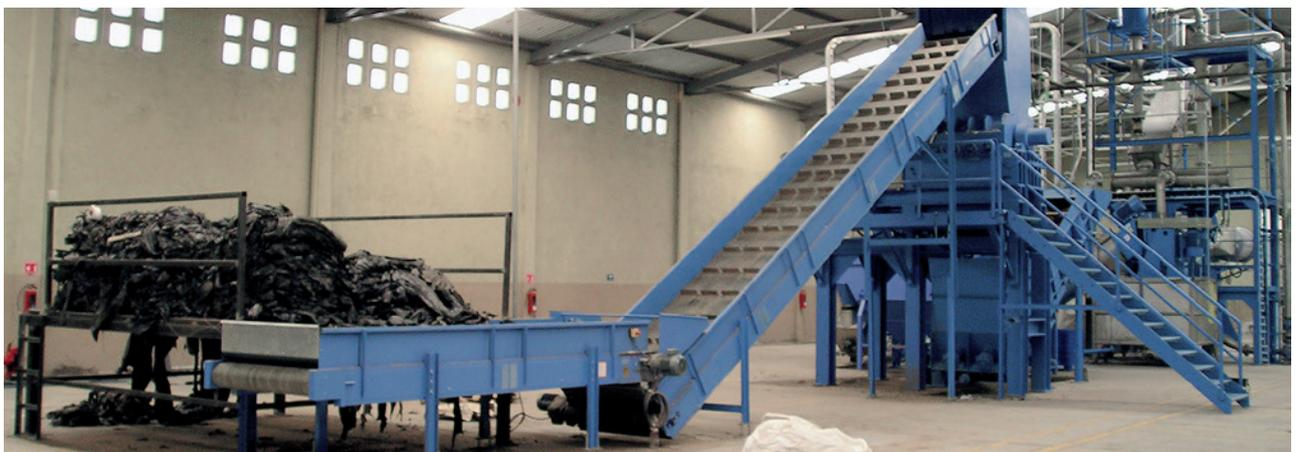
**Foto 3:** Cinta de transporte superior con mesa de clasificación para separar
