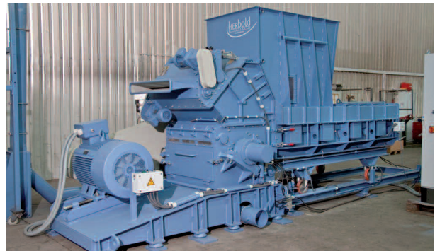
Fig. 3 : SML 60/100 HB avec système d'alimentation par rouleaux
