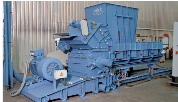
Fig. 2: SML 60/100 HB con entrada adicional por rodillos
