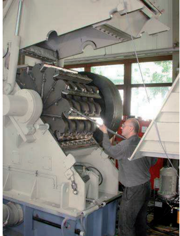
Fijación de cuchillas de rotor con una llave dinométrica en un granulador de tubos HERBOLD, tipo SMR 80/120
