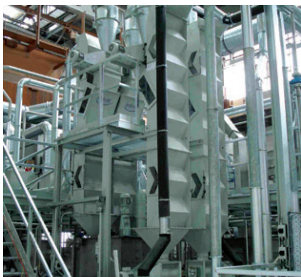
Fig. 1: Sistema de clasificación Herbald en una lavadora de botellas de PET
