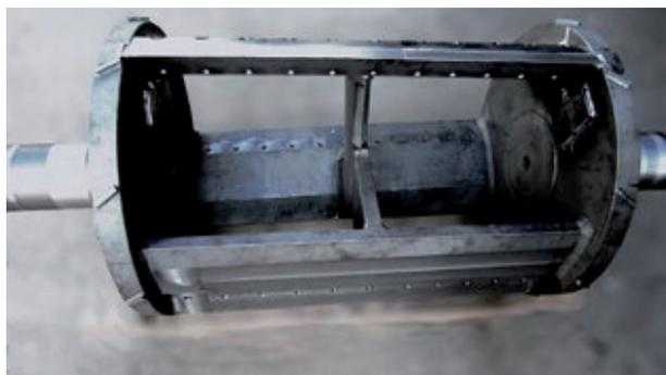
**Рис.1:** Гильотинный ротор без сплошного вала, со скребками между корпусом дробилки и внешним диском ротора.
