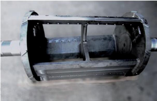
**Fig. 2:** Rotor de guillotina sin eje de rotor atravesado, con raspadores entre la pared de la carcasa y el disco de rotor exterior.
