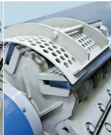
Einfache Siebentnahme über Rotor
