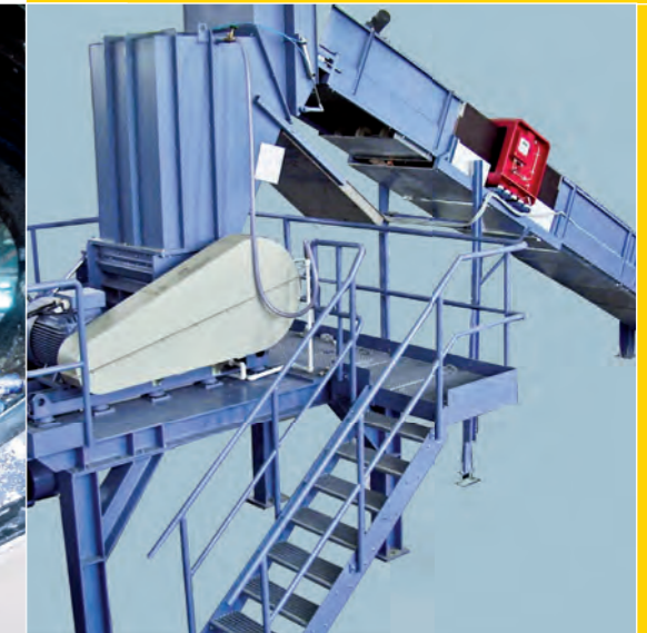
Ножевая дробилка для измельчения с водой
