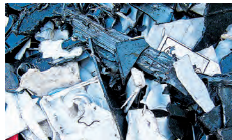
Ящики аккумуляторных батарей
