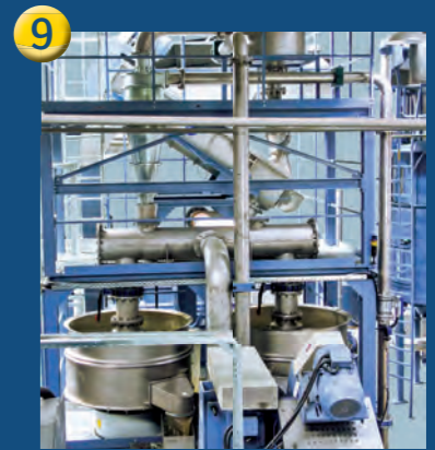
Высокоэффективная установка гидроциклонного разделения
