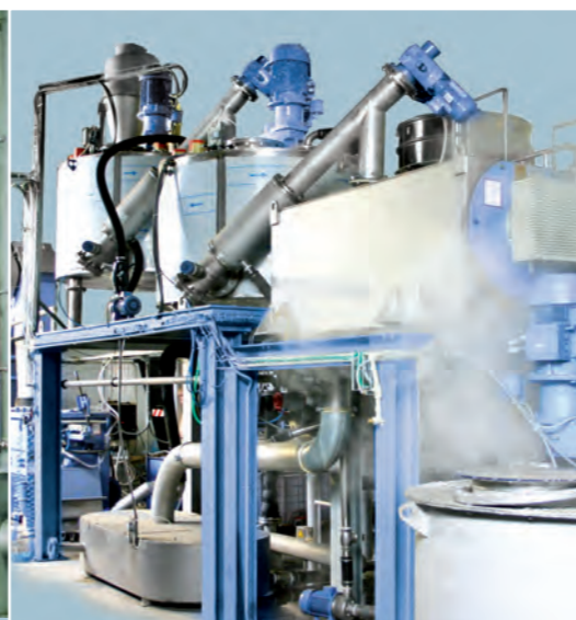
Установка горячей мойки
