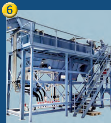
Установка предварительной мойки и отделения грубых загрязнений
