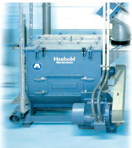
Broyeur humide avec plate-forme d'entretien. L'alimentation a lieu par l'étage en dessus. Le produit broyé et lavé tombe dans un laveur à frictions.
