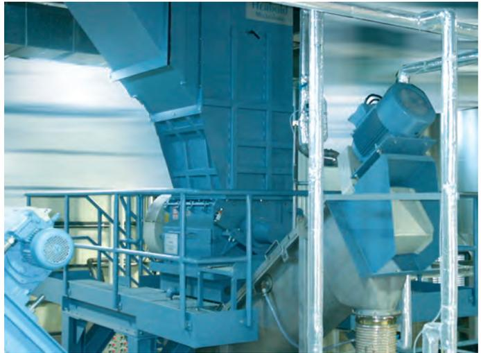
*Laveuse intensif avec nettoyage mécanique et décolmatage de la grille par jet d'eau*
