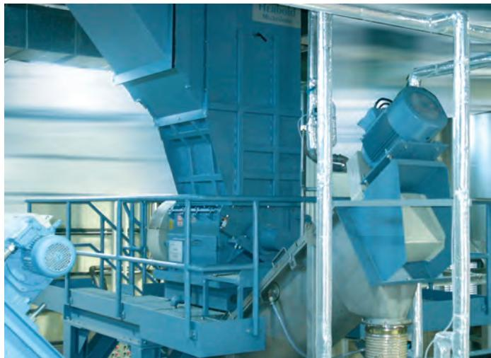
Laveur intensif avec nettoyage mécanique et décolmatage de la grille par jet d'eau
