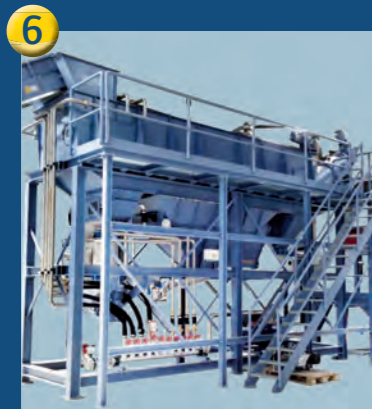
Unité de pré-lavage et séparation des particules grossières
