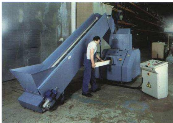
*SMP45/70 'C' с полной звукоизоляцией и дополнительным питателем коротких кусков*
