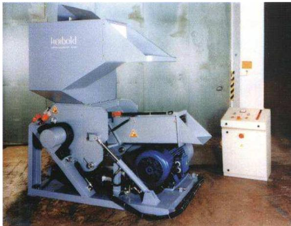
*SMP 45/70 с горизонтальной подачей и дополнительным питательным бункером, без звуковой изоляции*
