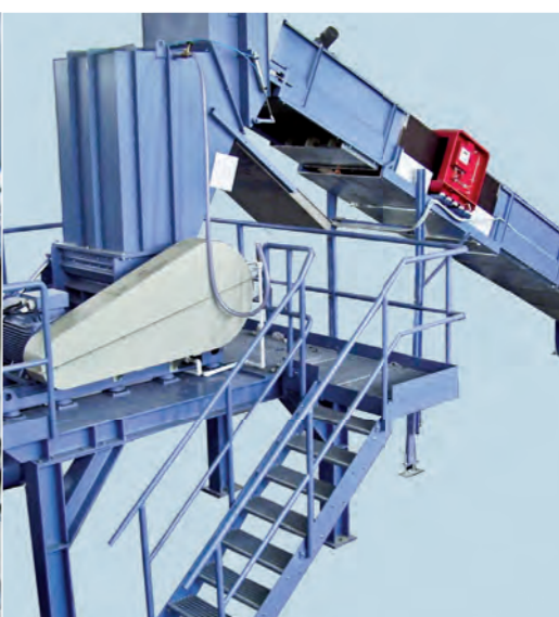
Broyeur SML en voie humide doté d'un détecteur de métaux et d'un clapet d'éclusement
