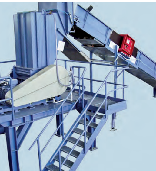
Molino de corte SML en ejecución para húmedos con separador de metales y trampilla de salida
