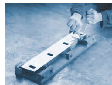
Einstellvorrichtung zum Voreinstellen der Messer außerhalb der Maschine
