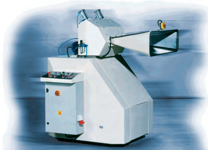
SML 35/42 C mit integriertem Schallschutz, Rolleneinzug und Rafftrichter
