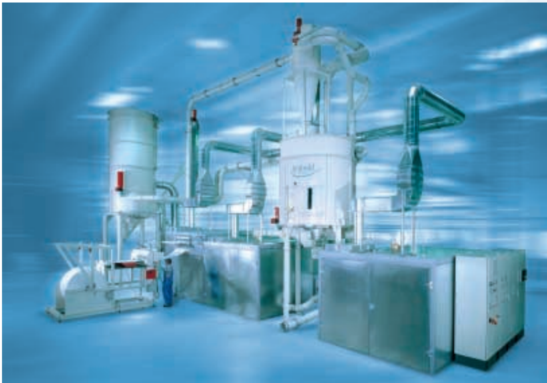
Gesamtanlage für Zellstoffpulverisierung mit Explosionsschutz
