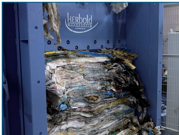
Рис. 2: Отделение частей материала, расположенного под расщепляющим ножом
