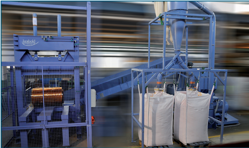
Рис. 3: Сочетание гильотины и ножевой дробилки с накопительным бункером
