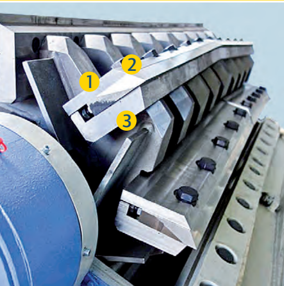
Rotor Serie F con protección contra desgaste recambiable
