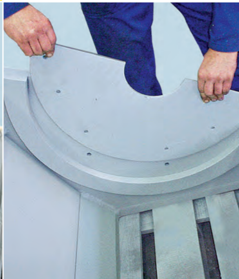
Blindaje de carcasa recambiable
