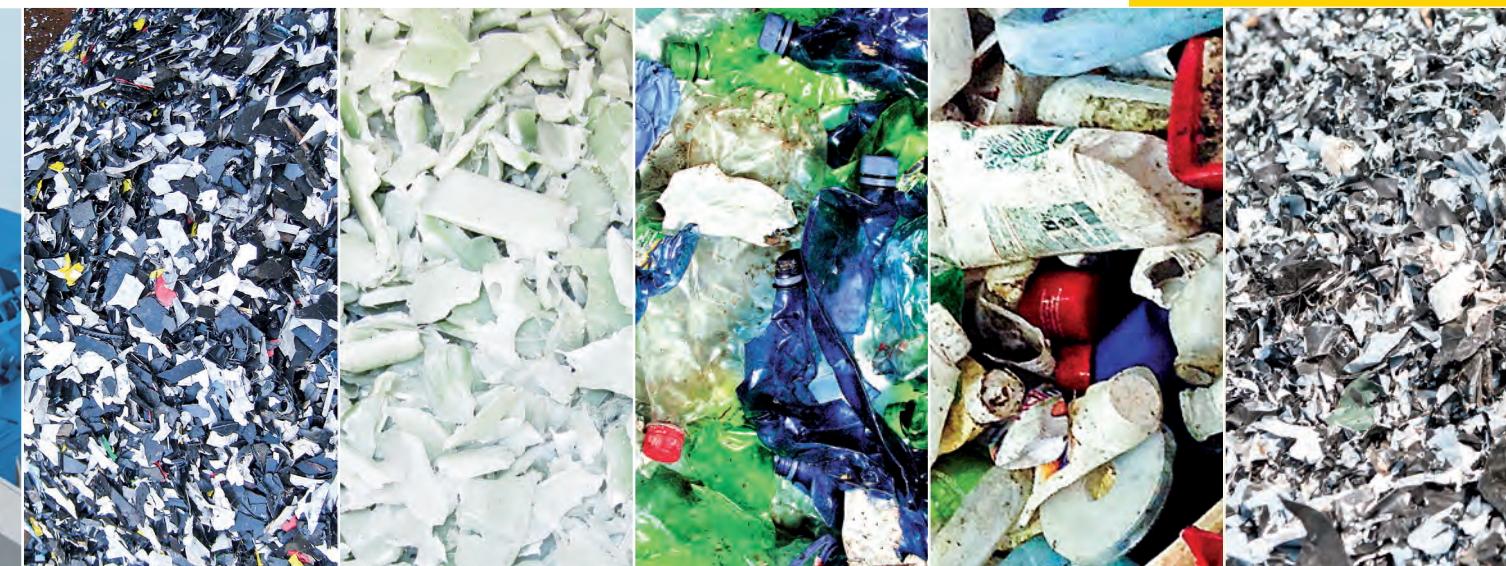
Ejemplos de materiales para triturar: Cajas de baterías previamente troceadas, Tubos previamente troceados, Botellas, Material HDPE, Folio precortado < 200 mm
