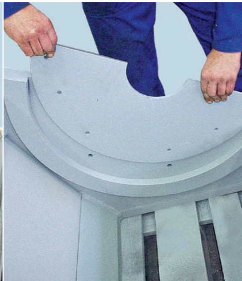
Сменная футеровка корпуса
