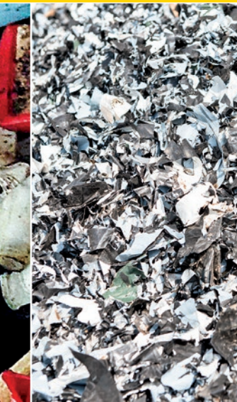
Предварительно измельченная шредером пленка < 200 мм
