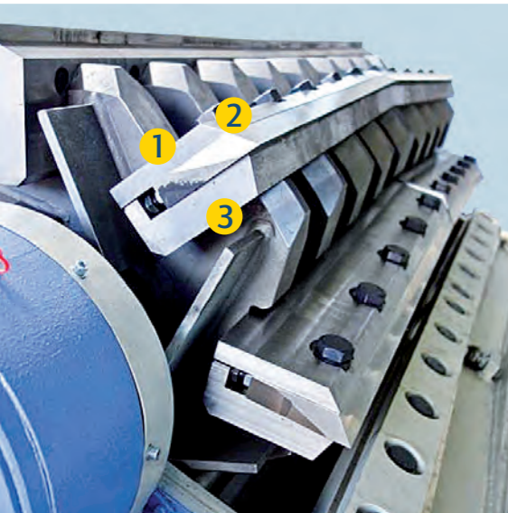
Rotor de la série F équipé de plaques anti-usure échangeables
