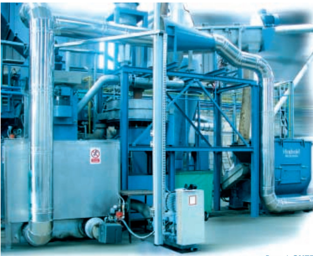
Unité de lavage à chaud pour flakes en PET
