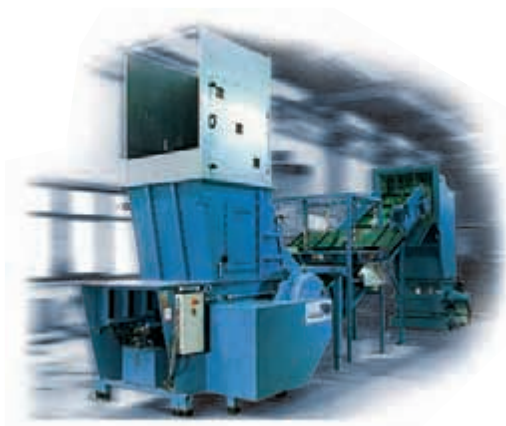
Zweistufige Zerkleinerungsanlage HR 155 und SML 60/100
