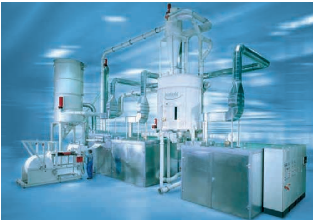
Feinmahanlage für Zellstoff mit drei SMF 500/1000
