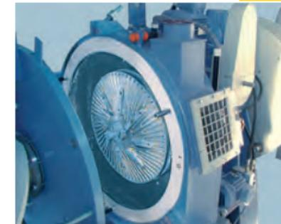
Корпус компактора HV 50
