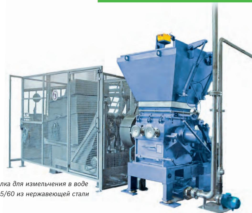
Дробилка для измельчения в воде SMS 45/60 из нержавеющей стали
