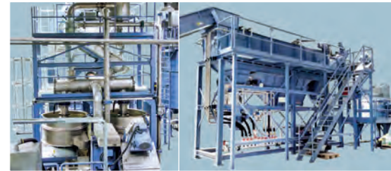
Unidad de hidrociclón
