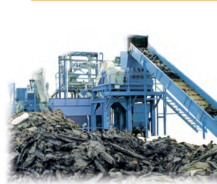
Línea de lavado de láminas procedentes de la agricultura
