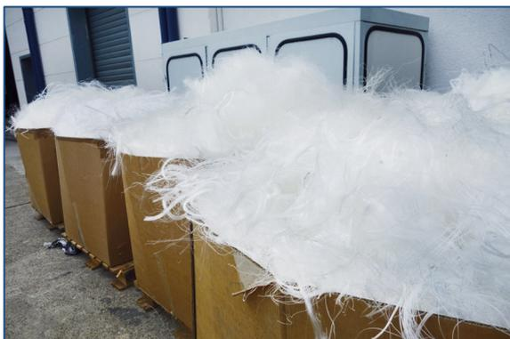
Abb. 1: PET-Filamente als Produktionsabfall
