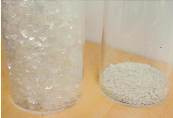
Die Abbildung zeigt 100g PET Folien vor und nach der Kompaktierung. Die Schüttdichte durch die Agglomeration mit dem HV steigt von 60 g/l auf 550 g/l.
