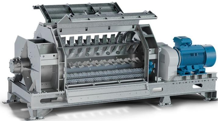
**Figura 1:** El nuevo secador mecánico T 150-300 establece estándares en tecnología de secado moderna y tiene una cesta de criba giratoria con boquillas de agua integradas para una limpieza completa y una rápida eliminación de la humedad.
