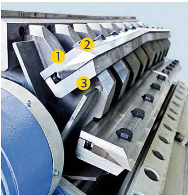
Abb. 4: Rotor Baureihe F mit auswechselbarem Verschleißschutz
