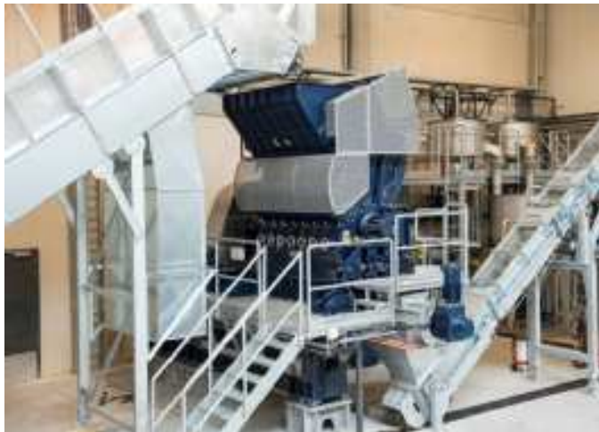
Foto 4) Desgarrador en húmedo Herbold HGM 60/200
