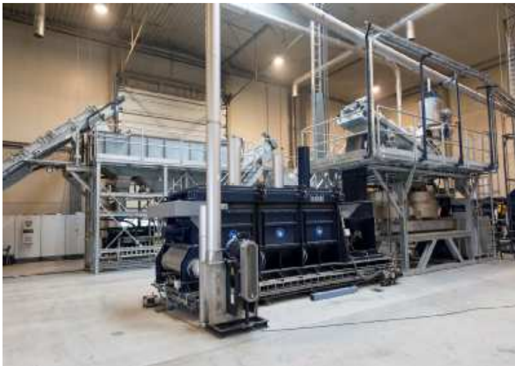
Рис. 3) Гидроциклон и сушилка, на заднем плане – установка предварительной мойки
