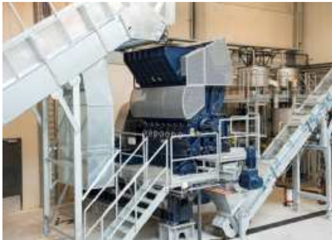
Рис. 4) Шредер с проточной водой Гербольд HGM 60/200
