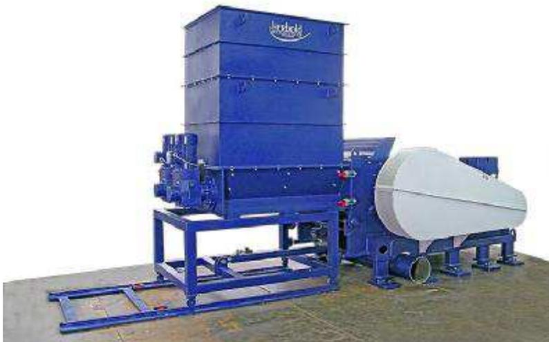
**Bouteilles en PET: un produit typique pour la transformation sur le nouveau broyeur HERBOLD avec alimentation forcée.**
