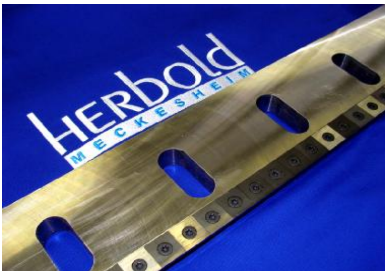
Fig. 1 : Couteaux stator dotés de pastilles échangeables en métal dur
