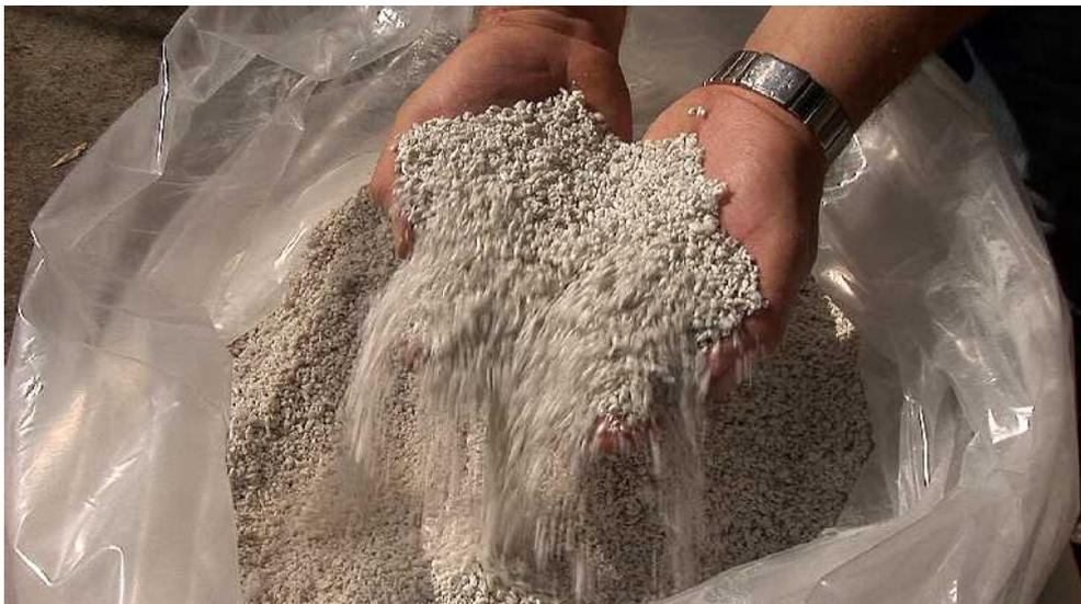
**Abb.1:** Als Endprodukt erzeugt der HERBOLD Plastikompaktor ein hochwertiges Agglomerat mit guter Rieselfähigkeit und Schüttdichte.“
