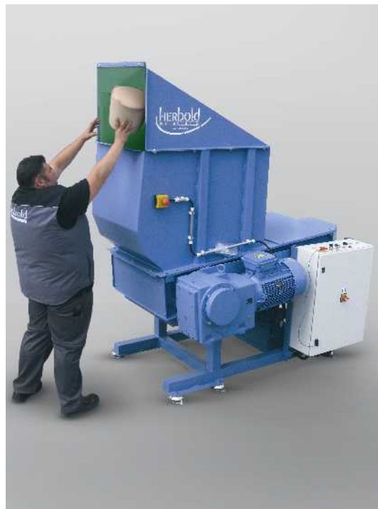
Abb.2: Herbold Einwellenshredder Typ HR 62P
