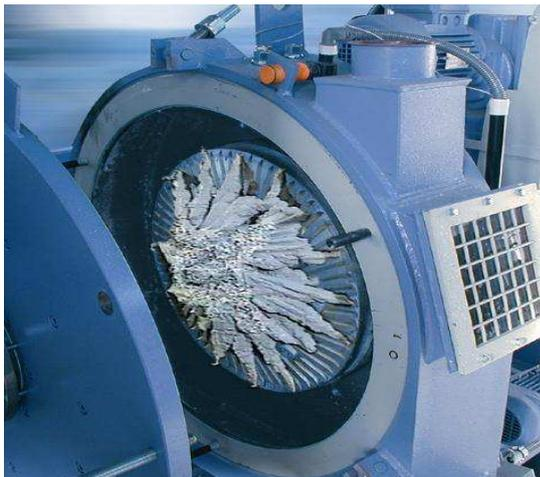
Abb.: HV Plastkompaktorscheibe
