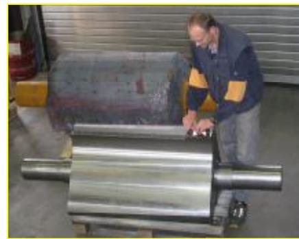
Abb.3: Rohling und Fertigteil A-Rotor
