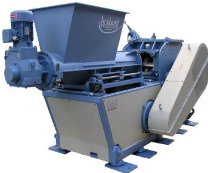
die bei Rotorabmessungen von 450x600 mm und 37 kw Antriebsleistung einen Durchsatz von 1,0 - 1,2 t/h beim Mahlen von PET-Flaschen erzielt (Sieb 12 mm).
