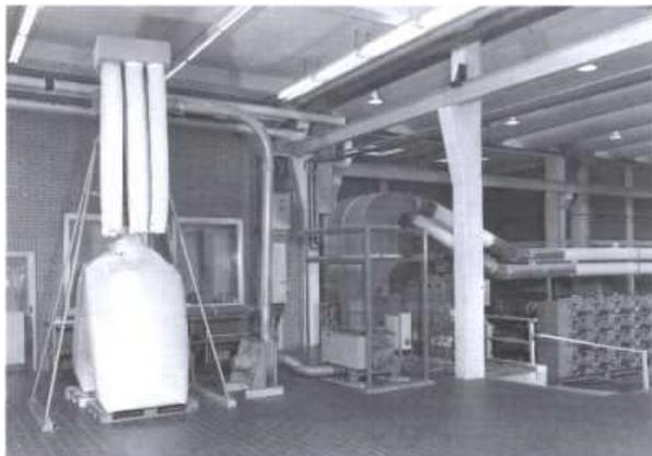
Herzstück dieses Konzepts sind Schneidmühlen der **Baureihe SML**. Diese Maschinen sind für diese Aufgabenstellung besonders gut geeignet, da
