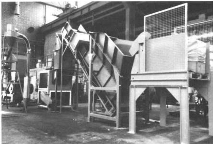
Als Zubehör für Zentralanlagen wird ein automatisches Beschickssystem vorgeschlagen, bestehend aus einer Kippvorrichtung für Behälter, einem Dosierförderband mit Metallsuchbrücke, sowie als der Mühle nachgeschaltete Einrichtungen ein Windsichter zur Abtrennung von Feinanteilen, Ablufffilter und Metallseparatoren.
