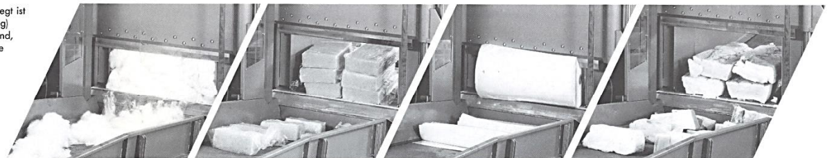
Besonders unfallträchtig: die Schlingenbildung beim manuellen Vereinzeln von faserförmigen Stoffen und Monofil-Abfällen (siehe Titelfoto). Mit der Guillotineschere wird dieses Unfallrisiko beseitigt.
